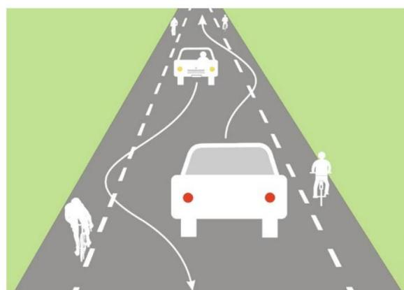
Principe de fonctionnement d'une CVCB
